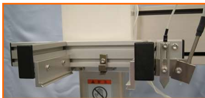
基板ハンガー部／半田供給部／液面検知部／カスカキ機構部
